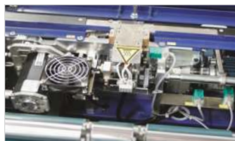
Głowica wiążąca bez pasek klinowych, łatwa w utrzymaniu
